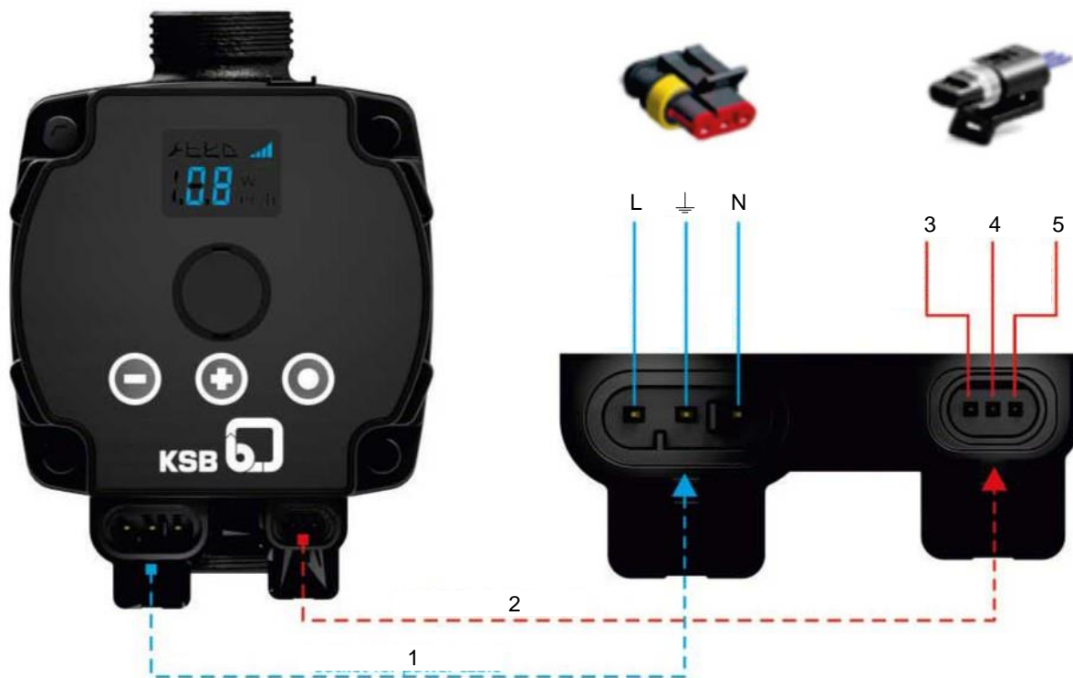
Рис. 9: Подключения кабеля питания и кабеля управления ШИМе
